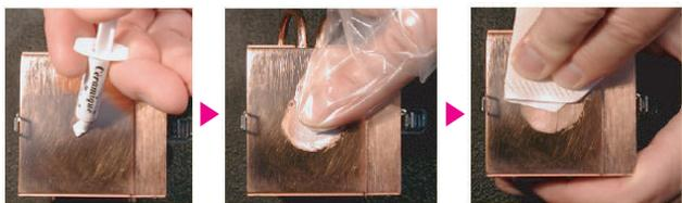
本製品をCPUコアに接触する面に適量を出します。(画像はAS-04です)
